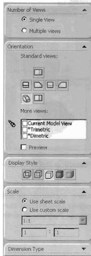
Slika 13-5 Deo panua Model View PropertyManager nakon biranja dokumenta za generisanje tehničkog crteža.
